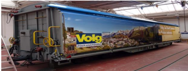
Haikq-qy 5163 Volg Ardez, Kühlaggregat neu
